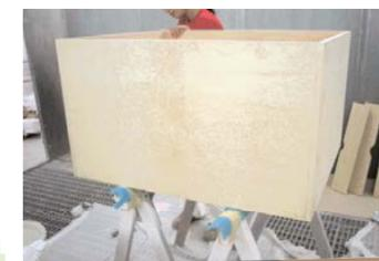
Cassettiera per cabina armadio di Fantini e Romagnoli in listellare laccato acero con trattamento a olio e cera. Nelle fasi di lavorazione è utilizzata la macchina scorniciatrice per il piallaggio, lo spessore e il taglio del materiale. Prima del trattamento a olio e cera, si procede alla fase di cartaggio del legno per la levigatura.
